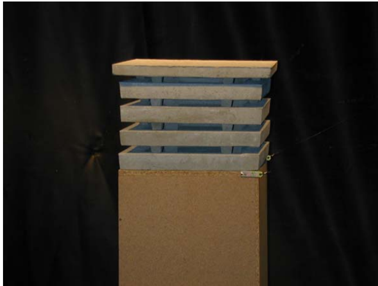
Determinación de la influencia del viento y su dirección en distintos tipos de chimeneas para la empresa Deflectores Modernos, S.L
