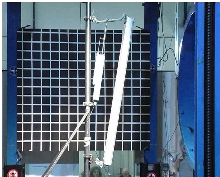
Verificación del comportamiento y estabilidad de antena de telefonía móvil para líneas ferroviarias de alta velocidad de la empresa CITEF.
