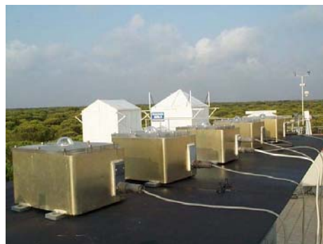
Intercomparación de radiómetros Eldonet en El Arenosillo
