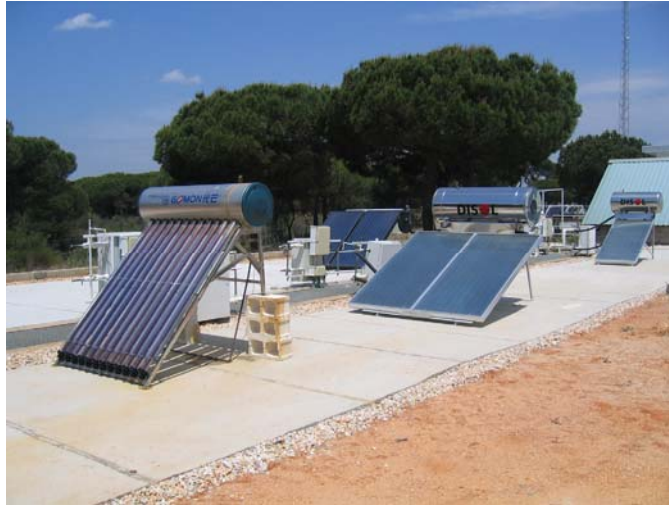
Bancada de ensayo de SSP rendimiento térmico
