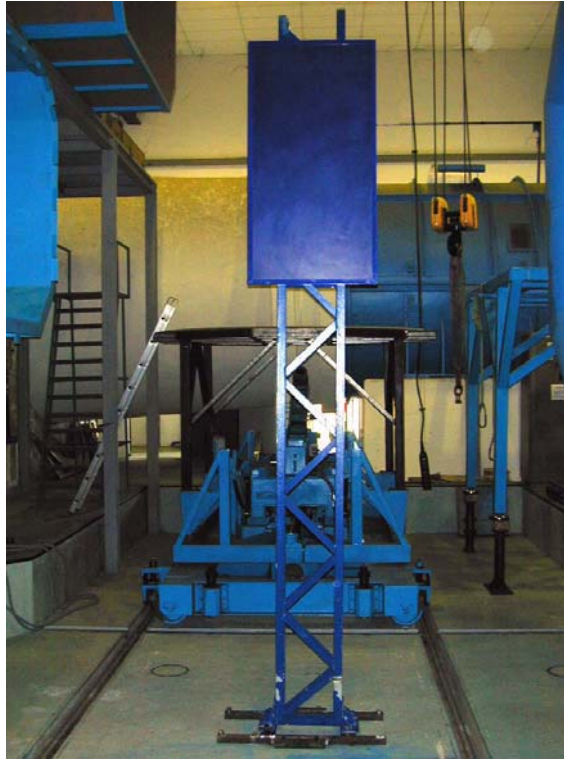
Verificación la resistencia y estabilidad de un cartel de señalización ferroviaria de líneas de alta velocidad para la empresa TECNIVIAL
