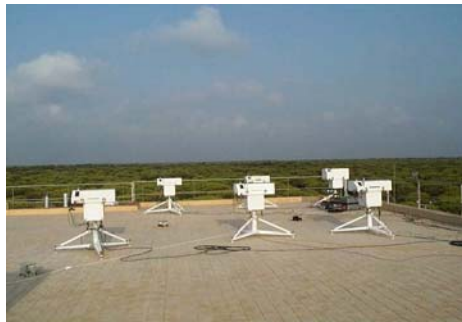
Intercomparación de espectrofotómetros Brewer en El Arenosillo
